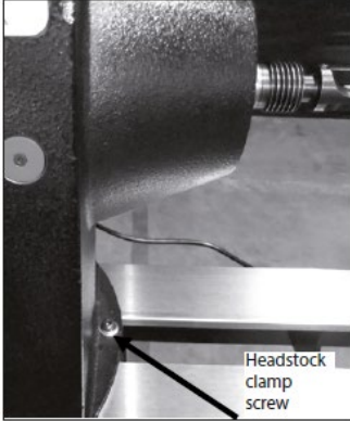
Headstock clamp screw – Az orsópálca rögzítő csavara
